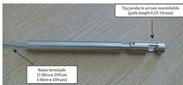
Figura 6: Particolare del probe (parte terminale) del biosensore per misure di assorbanza in soluzione.
