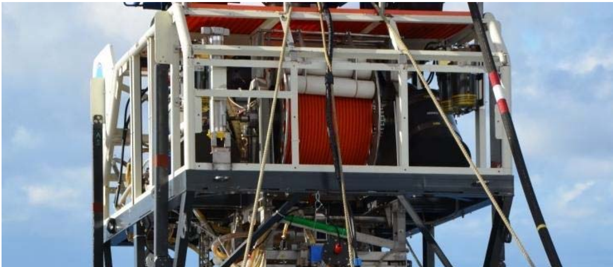
ROV (Remotely Operated Vehicle) utilizzato per le ricerche in ambienti profondi
